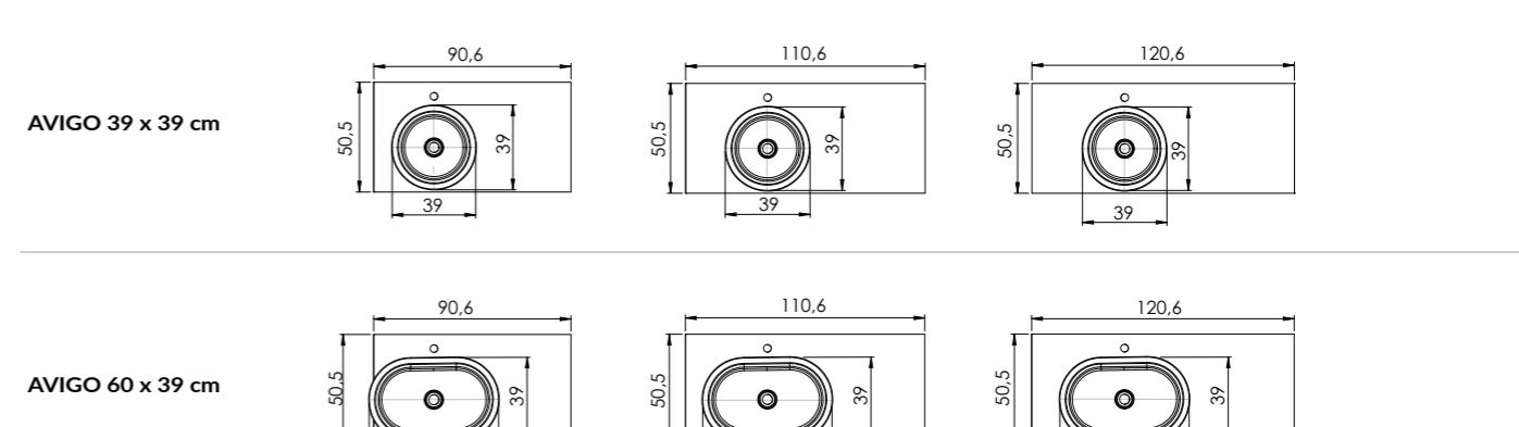
NB: i presenti disegni tecnici raffigurano il lavabo posizionato su top SX. Per il posizionamento su top DX, l'ingombro risulterà speculare.
