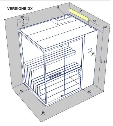
Installazione Ghibli Sauna ad angolo Dx. Per installazione ad angolo Sx i collegamenti sono speculari
