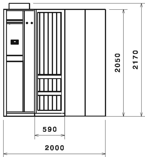
**Spazio necessario per il montaggio della sauna**
