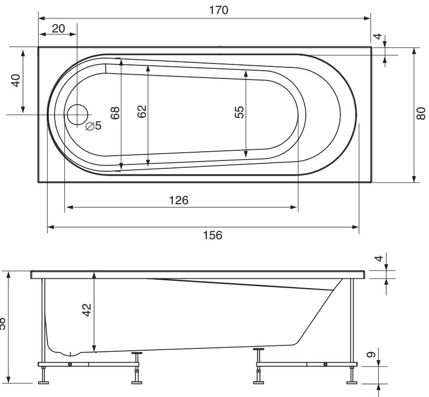
Se la vasca viene installata ad incasso, la muratura non può rientrare rispetto al bordo esterno più di 1 cm. Prevedere il pannello di ispezione e presa d'aria.
