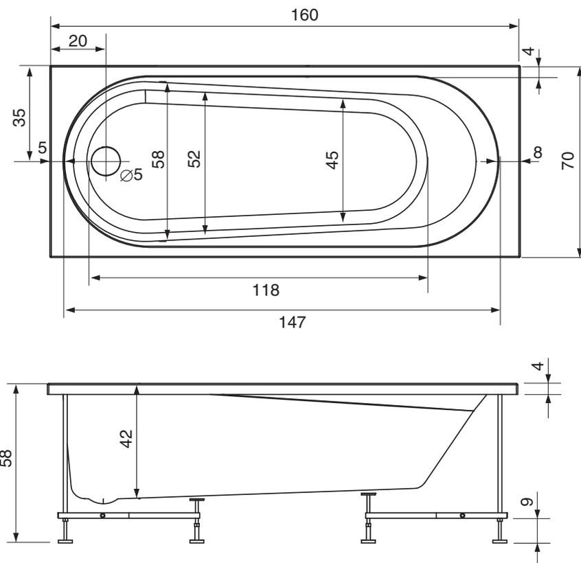
Se la vasca viene installata ad incasso, la muratura non può rientrare rispetto al bordo esterno più di 1 cm. Prevedere il pannello di ispezione e presa d'aria.
