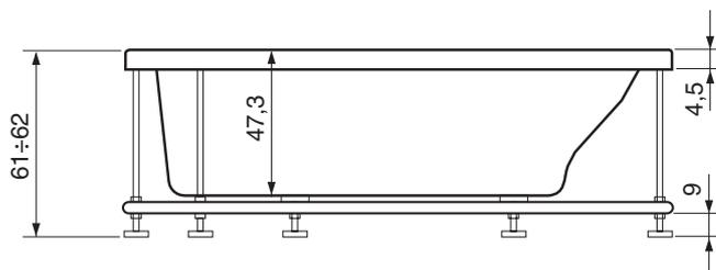
Se la vasca viene installata ad incasso, la muratura non può rientrare rispetto al bordo esterno più di 1 cm. Prevedere il pannello di ispezione e presa d'aria. L'ingombro della vasca aumenta di 3 cm se viene installato il pannello.
