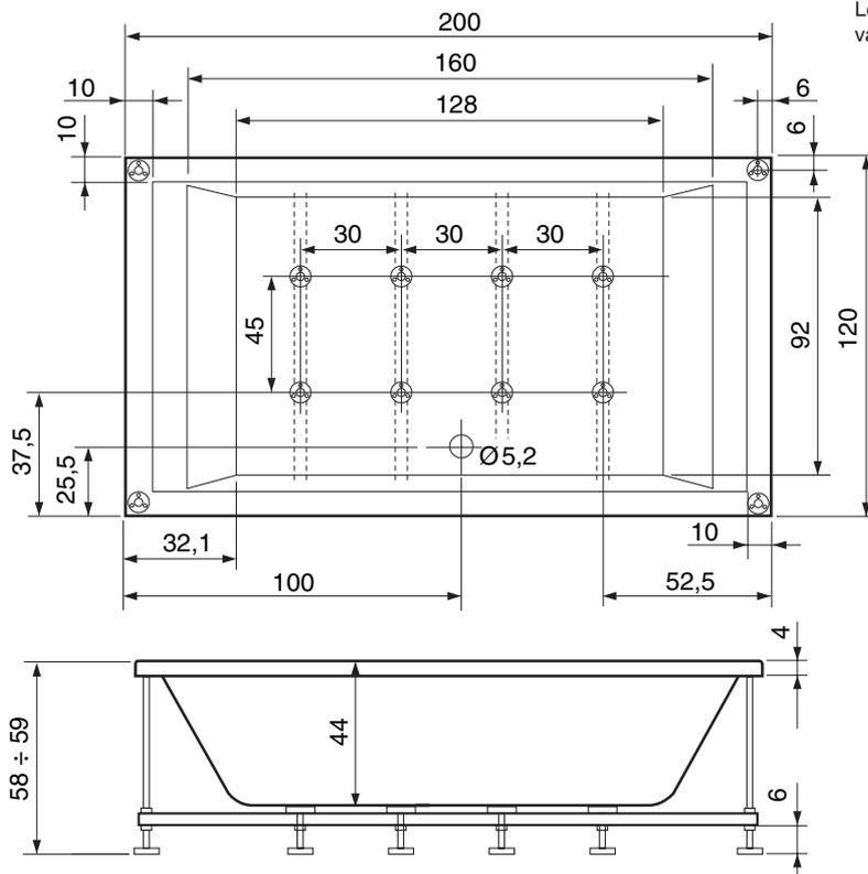
Se la vasca viene installata ad incasso, la muratura non può rientrare rispetto al bordo esterno più di 1 cm. Prevedere il pannello di ispezione e presa d'aria.
