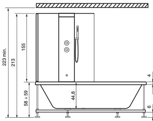
Se la vasca viene installata ad incasso, la muratura non può rientrare rispetto al bordo esterno più di 1 cm. Prevedere il pannello di ispezione e presa d'aria.
