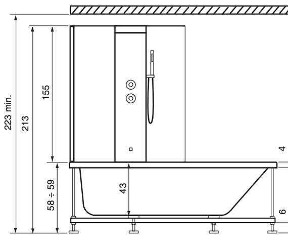
Se la vasca viene installata ad incasso, la muratura non può rientrare rispetto al bordo esterno più di 1 cm. Prevedere il pannello di ispezione e presa d'aria.
