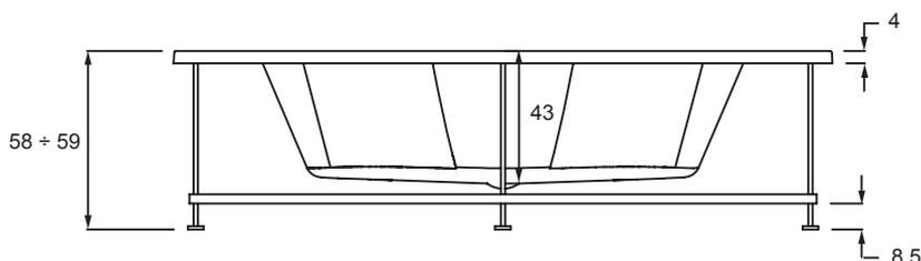
Se la vasca viene installata ad incasso, la muratura non può rientrare rispetto al bordo esterno più di 1 cm. Prevedere il pannello di ispezione e presa d'aria. L'ingombro della vasca aumenta di 3 cm se viene installato il pannello.
