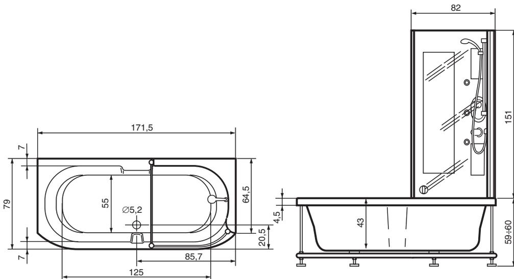
Se la vasca viene installata ad incasso, la muratura non può rientrare rispetto al bordo esterno più di 1 cm. Prevedere il pannello di ispezione e presa d'aria.
