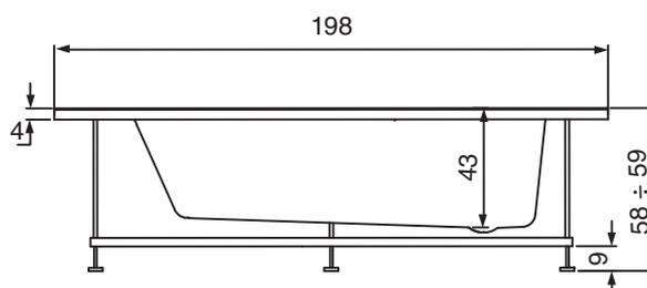
Se la vasca viene installata ad incasso, la muratura non può rientrare rispetto al bordo esterno più di 1 cm. Prevedere il pannello di ispezione e presa d'aria.
