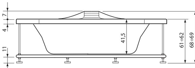
Se la vasca viene installata ad incasso, la muratura non può rientrare rispetto al bordo esterno più di 1 cm. Prevedere il pannello di ispezione e presa d'aria. L'ingombro della vasca aumenta di 3 cm se viene installato il pannello.
